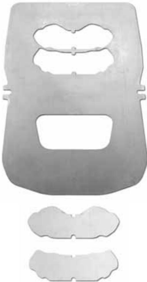
Les chutes sont réutilisées pour fabriquer les embases de piétement. L'assemblage de la structure et du piétement s'effectue ensuite par soudure robotisée. Pour finir, le siège est laqué au four. La coque amovible d'assise et de dossier, finement grainée, souligne le raffinement du dessin. Un système de fixation invisible la solidarise à la structure.
